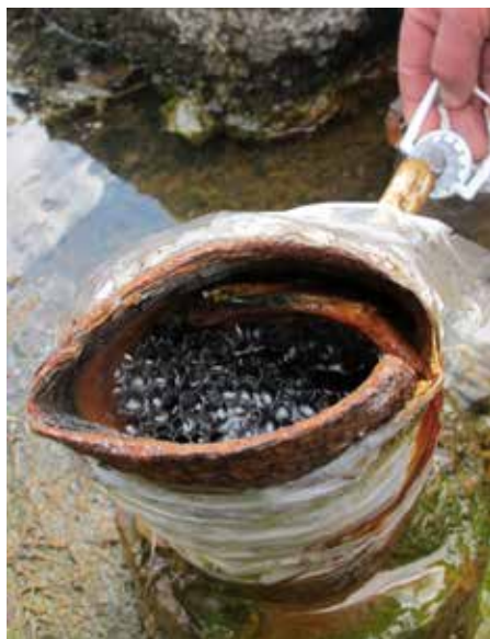
Фото.3. Выделение и горение газа в скважине №10000 (осенью и летом)
