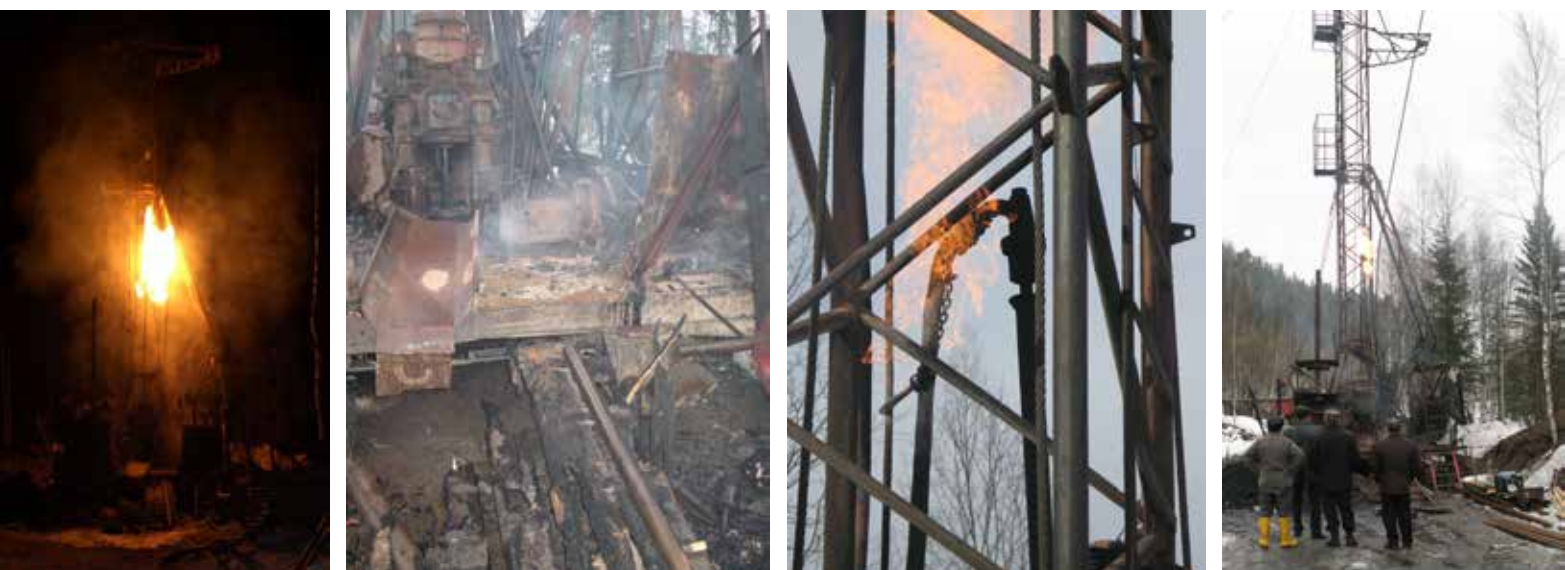
Фото.2. Состояние буровой Сква.11020 через 3 часа (ночью) после возгорания и утром.
