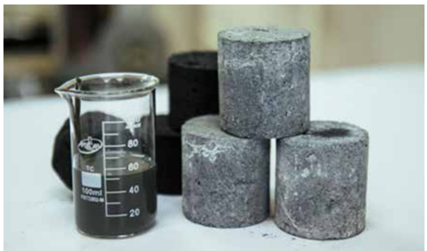
Фотографии алюмосиликатного клея и брикетов из коксовой мелочи и пыли на основе связующего из золы уноса
