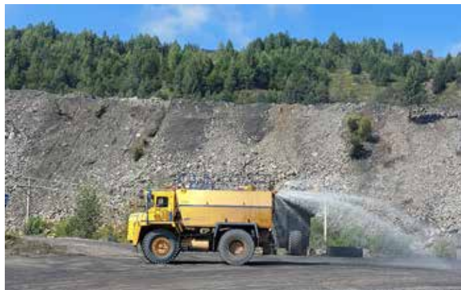
Для борьбы с пылью на технологических дорогах предприятий компании применяется гидрообеспыливание
