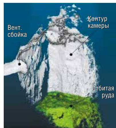
Результаты сканирования GoSLAM RS. Ручной сканер для мобильного лазерного 3D-сканирования GoSLAM с дальностью до 120 метров может работать даже при низких температурах
