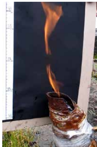
Фото.3. Выделение и горение газа в скважине №10000 (осенью и летом)
